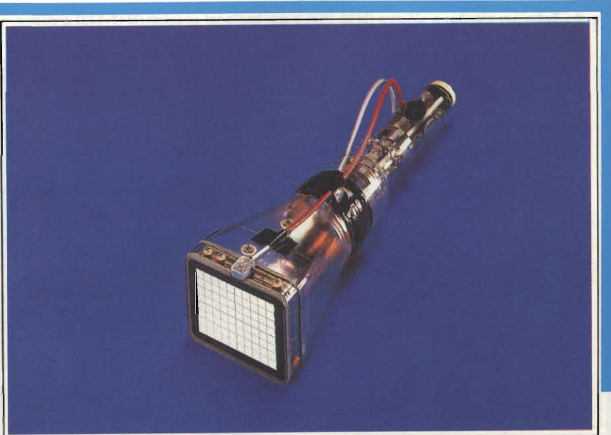
Fig. 6 - Tubo con schermo memoria (storage tube), L14-140 GH/95.
